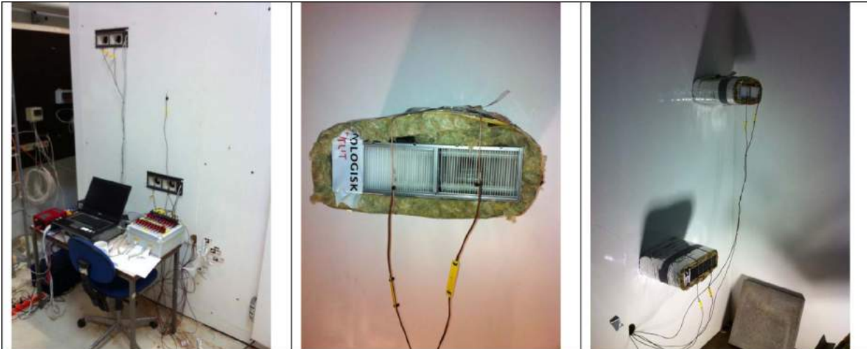
Forsøgsopstilling i frostrum og tilhørende datalogger system.
